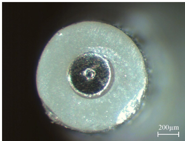
Abb. 3.14: Ansicht der fertig bearbeiteten 50 \mu\text{m} Zylinder-Elektrode.
