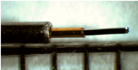
Abb. 3.10: Grundbestandteile der 200 \mu\text{m} Zylinder-Elektrode: links Pt-Röhrchen, Mitte Polyimid-Röhrchen und rechts 200 \mu\text{m} Pt-Draht. Der Abstand zweier Striche beträgt 1 mm.
